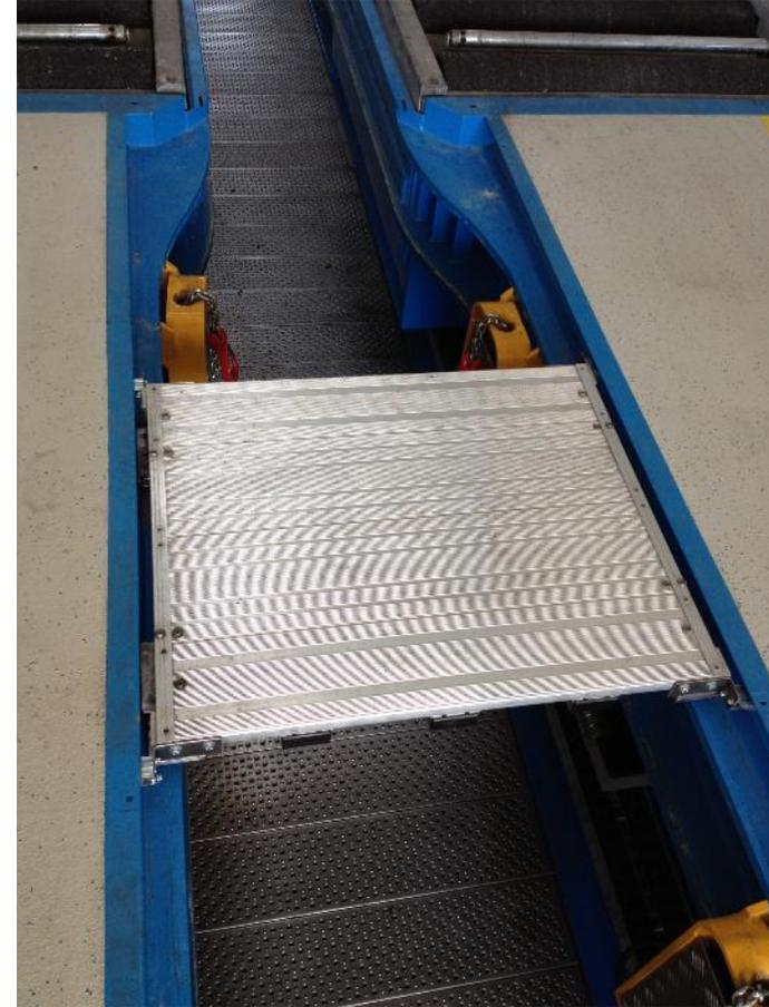
Busluken für den unteren Arbeitsbereich des Fahrwerks / Motoren
