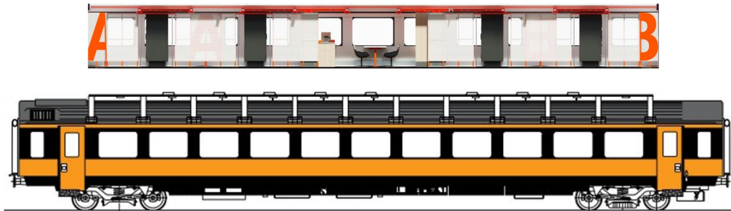
Seitenansichten Laborwagen innen und aussen: Testzonen, zentraler Aufenthaltsbereich, Antennenträger
