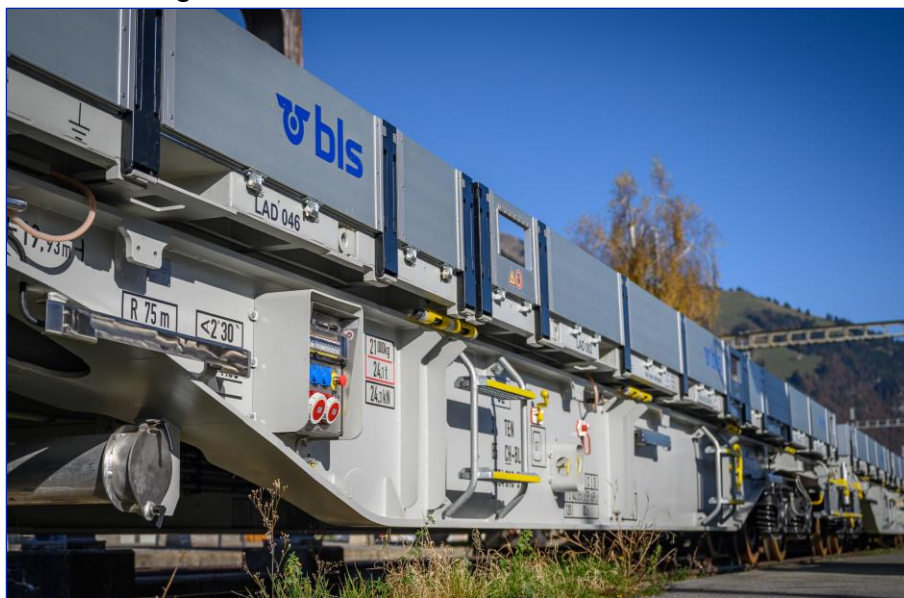
Wagon porteur modulaire long à 4 essieux avec surfaces de chargement
