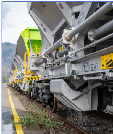
Déversement de ballast avec arrosage
