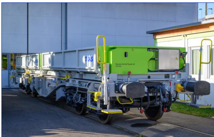
Wagon porteur court à benne basculante à 4 essieux
