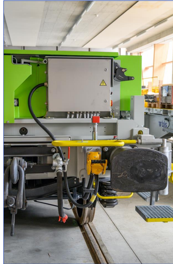
Alimentation du module en courant triphasé
