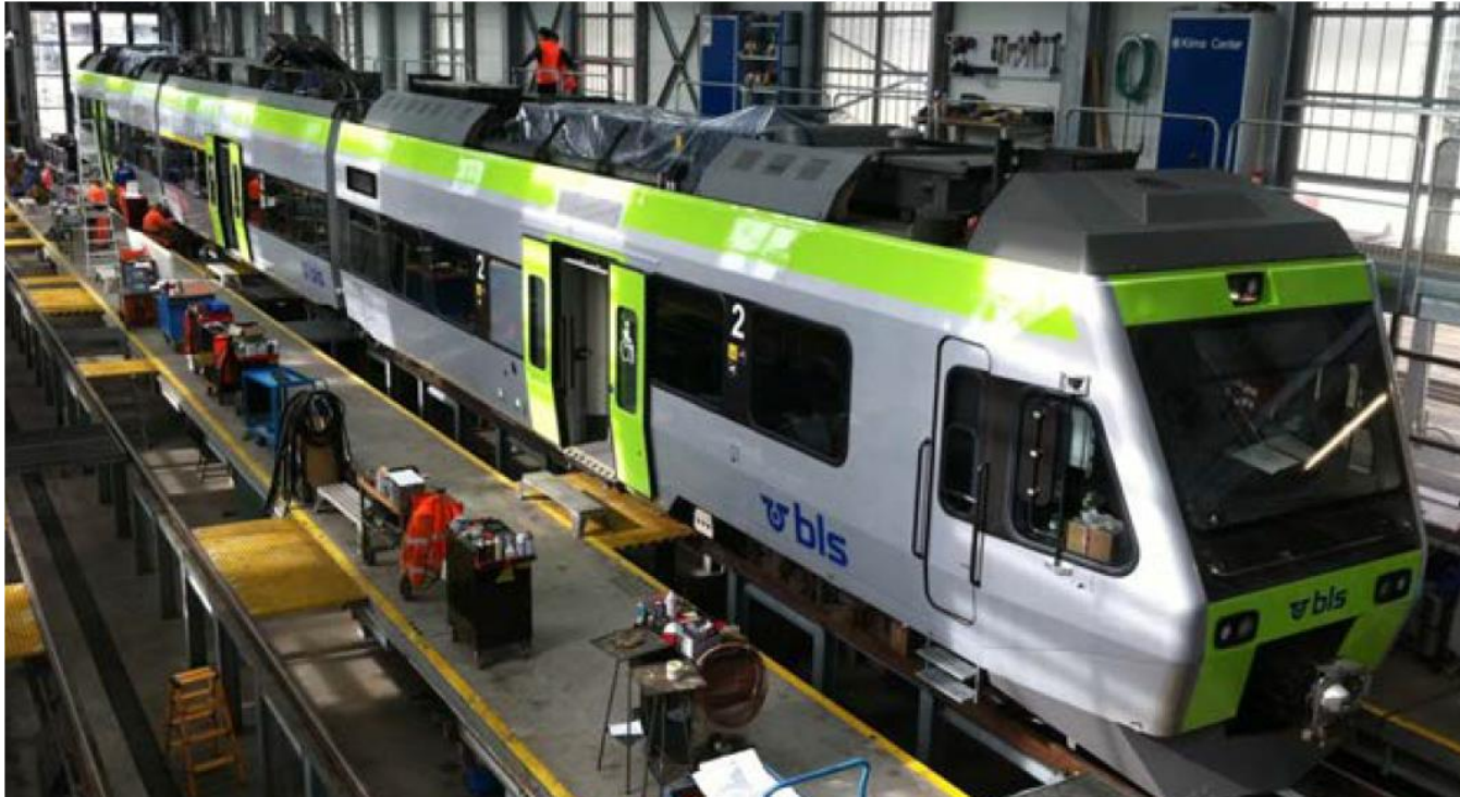
Umbau Wärmedämmung und laserbehandelte Fenster Nina BLS
