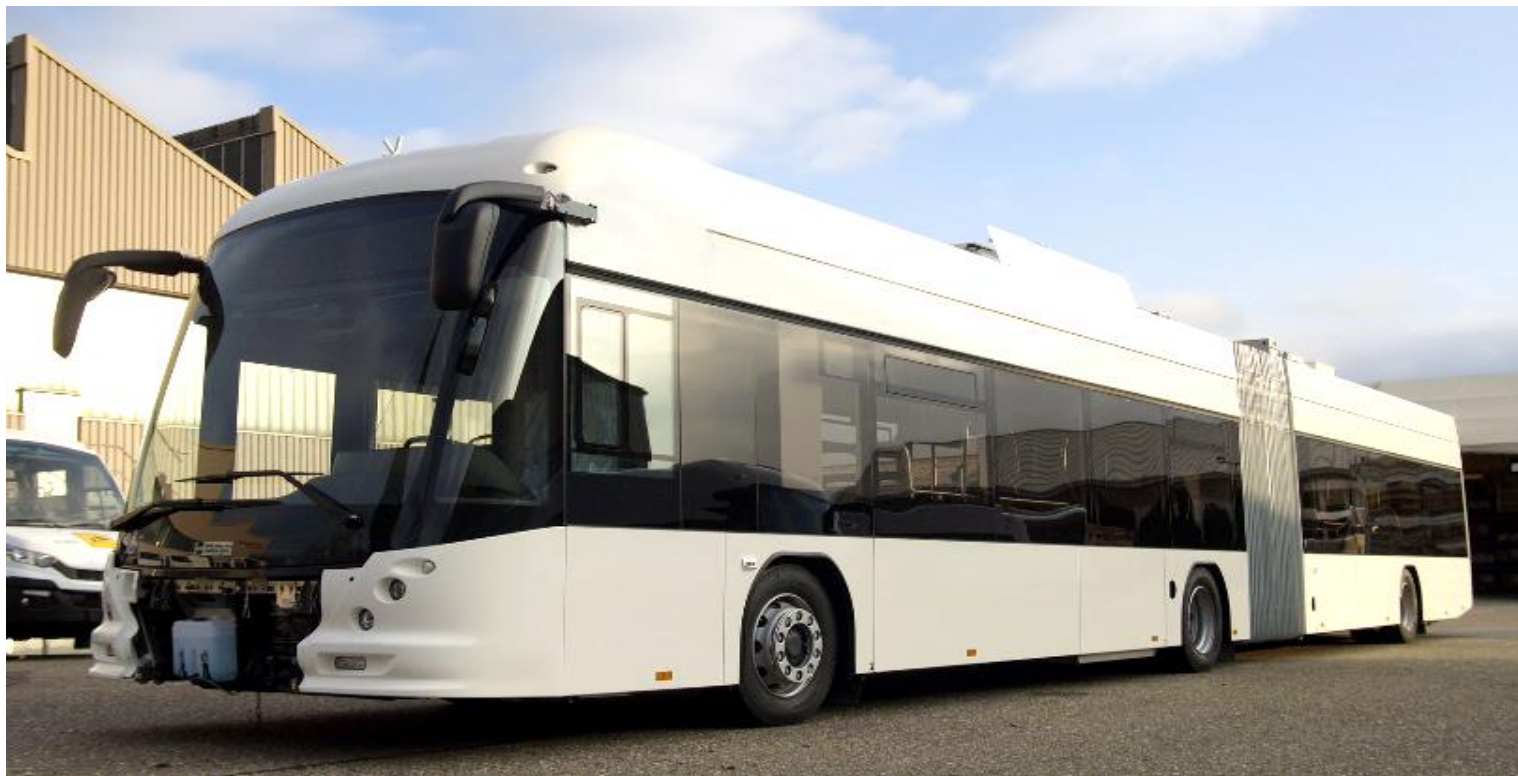
Trolleybus mit Batterie-Range-Extender-Modus. Quelle: Hess
