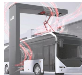
Arrêt Kleinhüningen 2 OC (450 kW)
