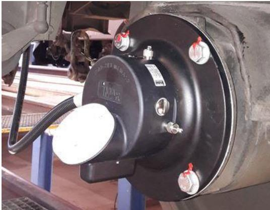
**Abbildung 10-5: ZET2 Version2 auf Funkmesswagen mewa12 installiert**
