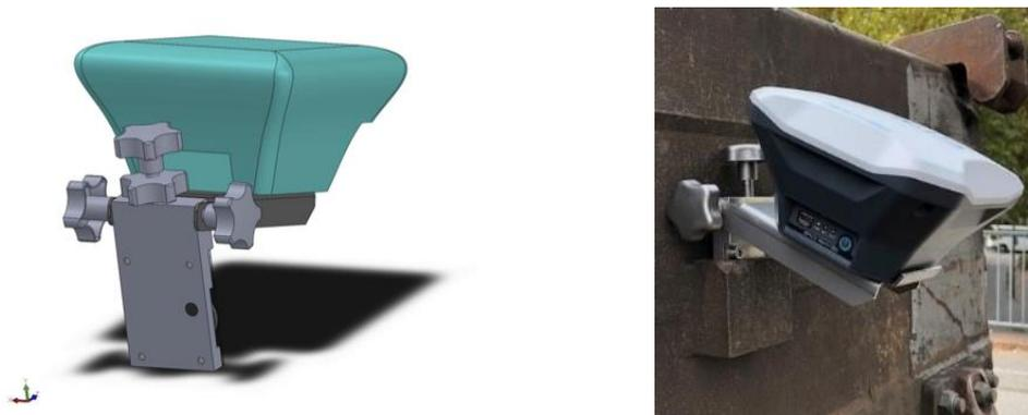
**Abbildung 10-1: ZET1 mit Modifikation der Exzentrissicherung durch eine zusätzliche Rändelschraube**
