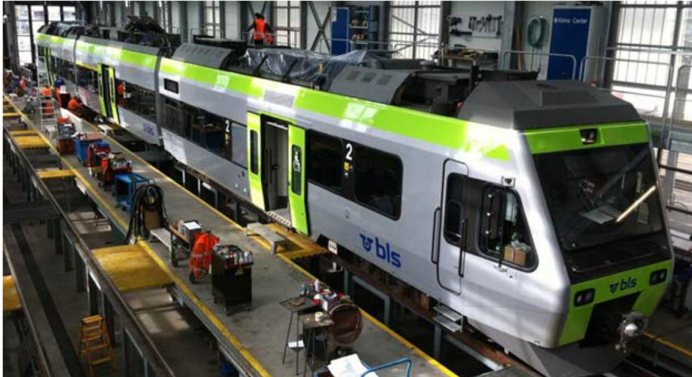
Transformation de l'isolation et équipement avec fenêtres traitées au laser de la flotte Nina, BLS
