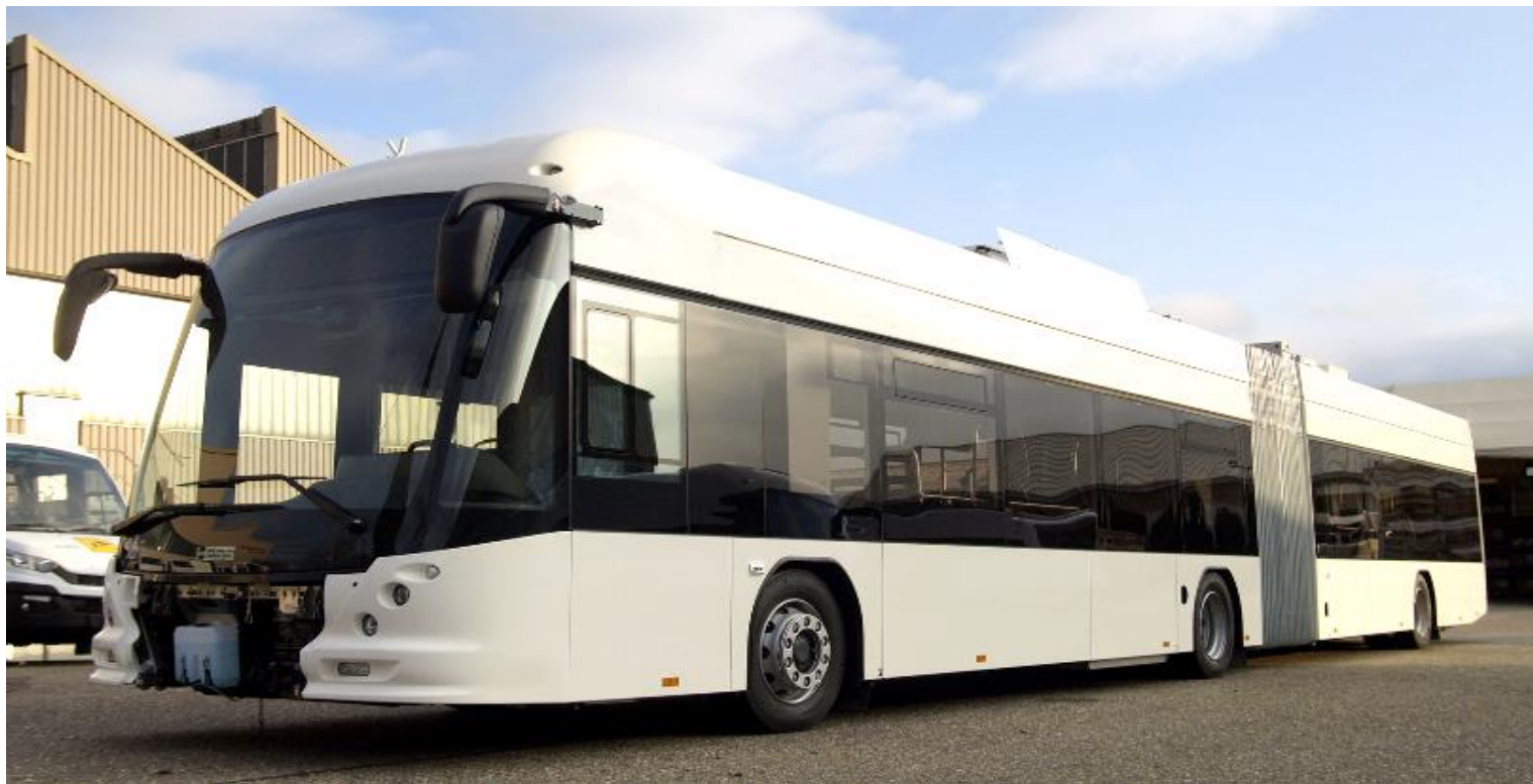
Trolleybus avec module Batterie-Range-Extender. Source: Hess
