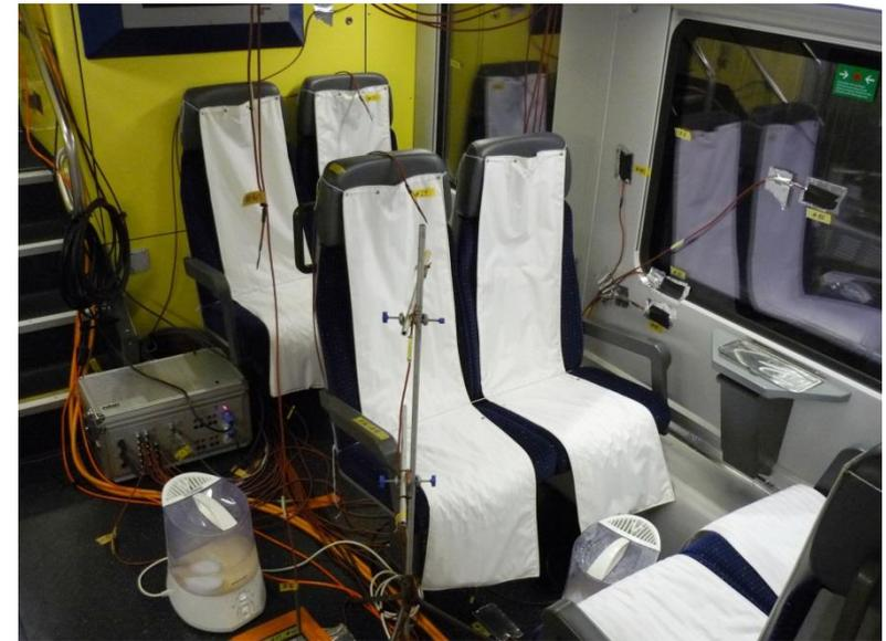
Pro Fahrzeug wurden gegen 250 Sensoren zur Erfassung, Beurteilung des thermischen Komforts sowie ca. 30kW Wärmelasten & Luftbefeuchter eingebaut, um die Abwärme der Fahrgäste & den Einfluss der Sonne zu simulieren. Hierzu wurden ca. 5'000 m Kabel im Fahrzeug installiert
