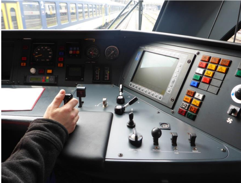
Fahrbremsschalter eines FLIRT
