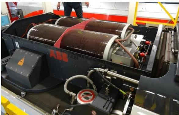
RESIBLOC® Dry Type Traction Rolling Stock Transformer, anlässlich einer Betriebsinspektion in der Werkstatt Samstagen der SOB. Gut erkennbar ist, dass die Staubablagerungen auf dem Trafo marginal sind. (Foto: Andreas Gerber)
