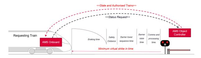
FIGURE 22 - MINIMUM AND PRACTICAL VIRTUAL STRIKE-IN TIMES AT TYPICAL MULTI-TRACK LEVEL CROSSING
