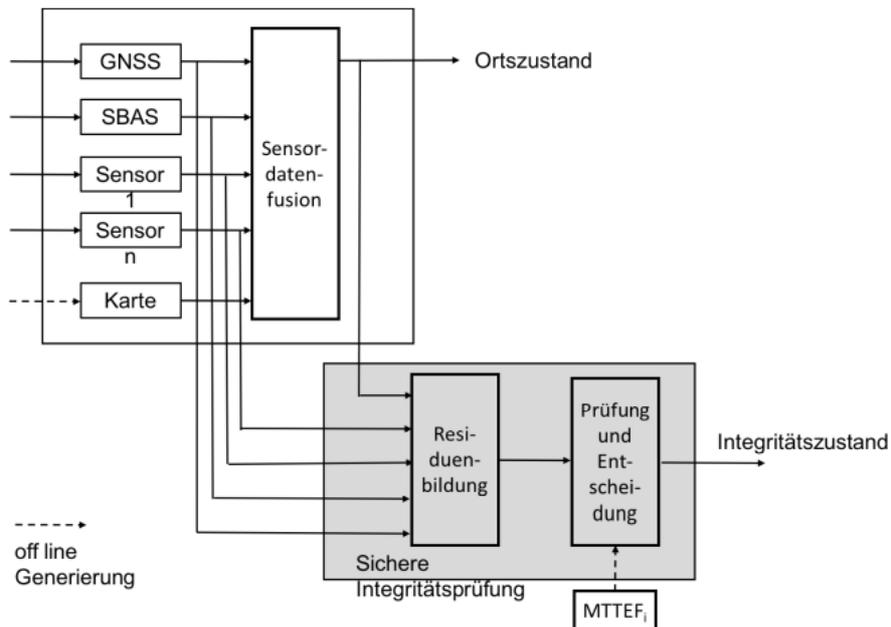
Figure 5-2: Functional architecture of a localisation system with safe integrity check (from “Machbarkeitsstudie für eine genaue, sichere Lokalisierung” [26])
