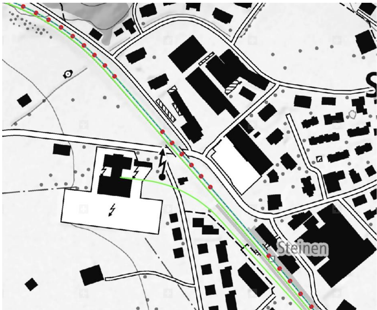
Abbildung 3-9: Beispiel eines GNSS integritätsbedingten «virtuellen» Tunnels
