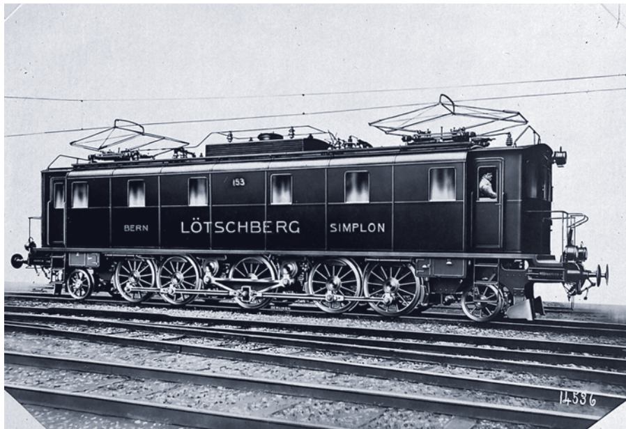
Die von SLM und MFO bzw. BBC gelieferten Fb 5/7 sind die ersten Serienloks der BLS. Mit ihren 2500 PS sind sie zu jener Zeit die stärksten Lokomotiven der Welt. Die Be 5/7 Nr. 160 präsentiert sich hier kurz nach Inbetriebnahme.
