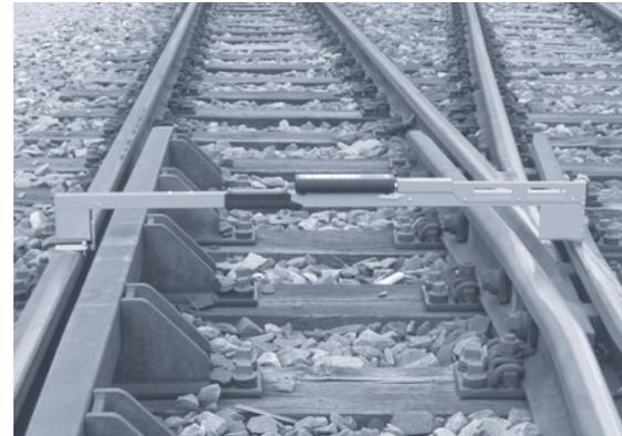
Messung der genauen Spurweite an einer Meterspur-Weiche.
