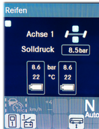
Unterschiedliche Darstellungsvarianten des Reifendruckkontrollsystems Gesamtansicht / Achsansicht Einzel- bzw. Zwillingsbereift
