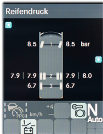
Unterschiedliche Darstellungsvarianten des Reifendruckkontrollsystems Gesamtansicht / Achsansicht Einzel- bzw. Zwillingsbereift
