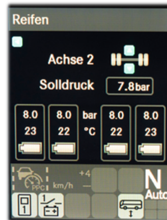
Unterschiedliche Darstellungsvarianten des Reifendruckkontrollsystems Gesamtansicht / Achsansicht Einzel- bzw. Zwillingsbereift
