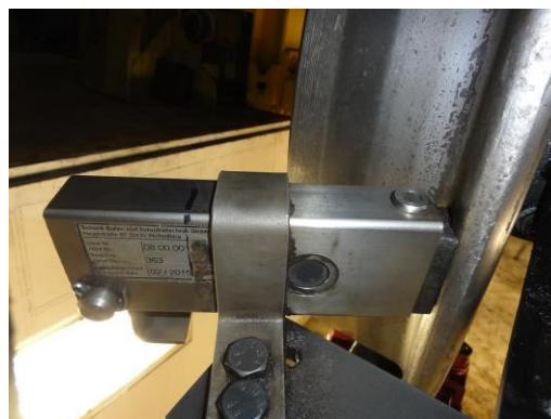
Illustration 5-5 : Montage du dispositif de véhicule avec système de lubrification solide
