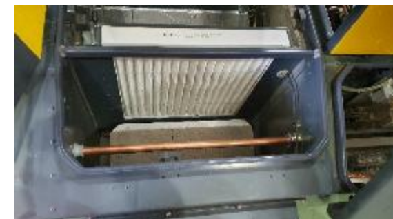
Rohrdurchführung ohne Lötverbindungen
