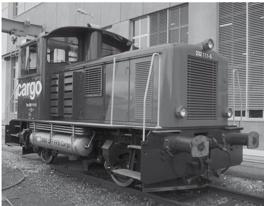
Les nouvelles locomotives de manœuvre diesel sont en principe toutes équipées de filtres à particules. Les CFF équipent également de filtres à particules leurs anciennes locomotives, comme ici la Tm 232 âgée de 30ans, dans le cadre d'un programme de mise à niveau.
