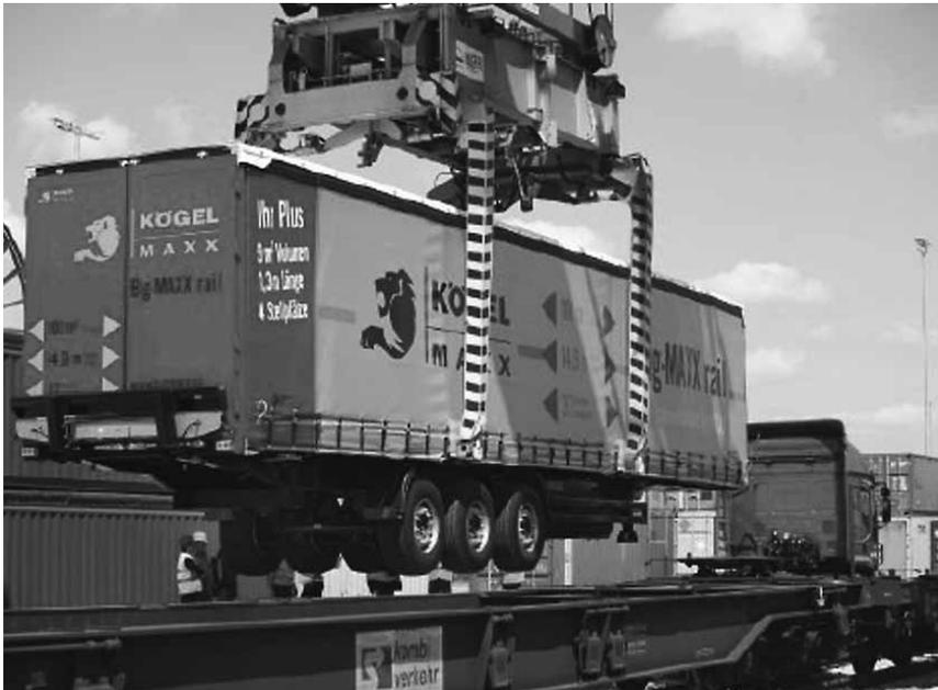
Un semi-remorque est placé dans le creux du wagon-poche. Le cadre doit être renforcé afin que la grue puisse soulever la caisse dont le poids peut aller jusqu'à 30 tonnes.
