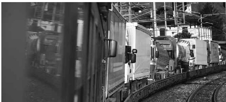
Train de la chaussée roulante; la faible hauteur des wagons, due au petit diamètre des roues, est bien visible et permet des transports à travers des profils de tunnels datant de l'ère des trains à vapeur.
