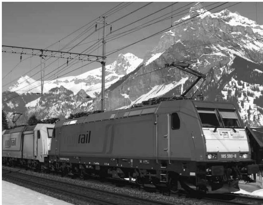
Double traction d'un train-bloc de conteneurs de Crossrail par deux locomotives de la série 185.
