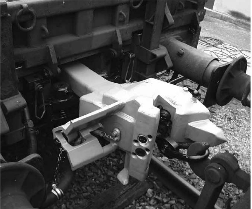
Attelage automatique Faiveley, combiné avec un attelage traditionnel (non visible ici). Dans cette configuration où les tampons demeurent, certains avantages de l'attelage automatique sont annulés, comme la réduction de l'usure des voies.
