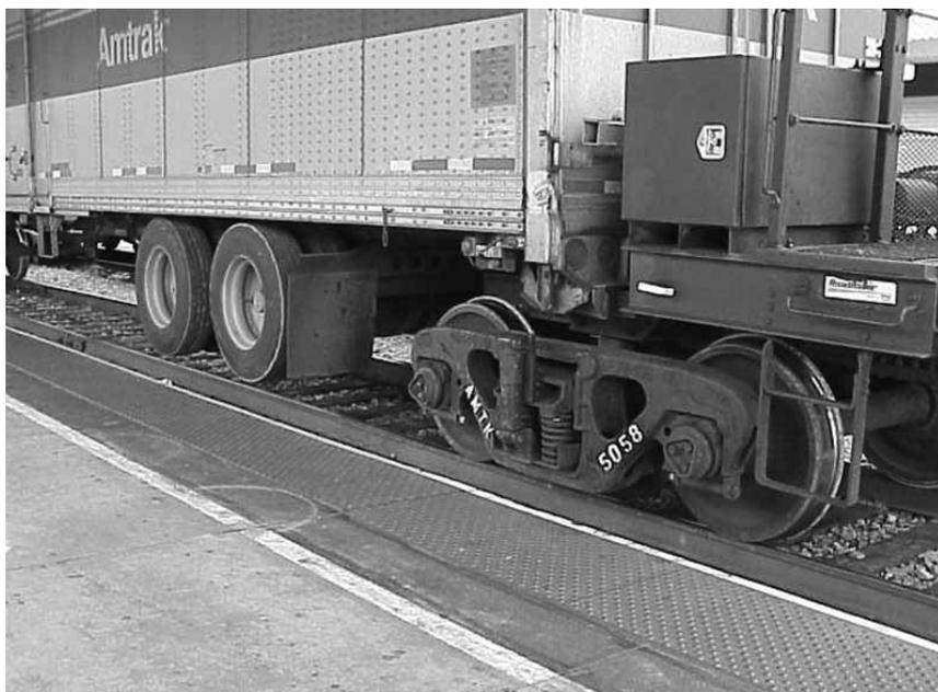
Roadrailer: le poids lourd repose sur le bogie, avec sa partie arrière renforcée (d'où une moindre charge utile) bien visible. Le présent bogie est un bogie de jonction, plus complexe.
