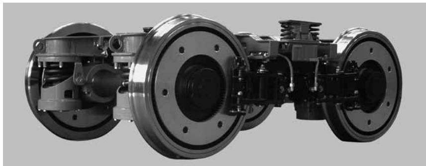
Le bogie novateur LEILA, avec ses freins à disque bien visibles au plus près de la roue et ses amortisseurs hydrauliques, cachés ici au milieu du bogie.
