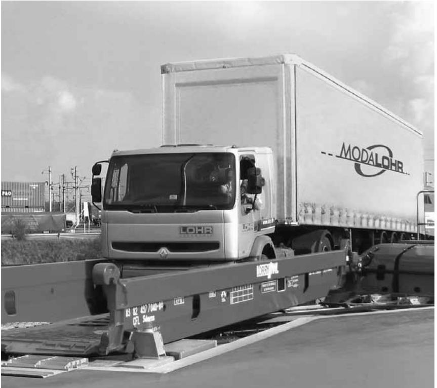
Le principe de chargement Modalohr pour la chaussée roulante française: la partie mobile du wagon ferroviaire pivote en diagonale, puis est remise dans la direction de la marche et verrouillée.
