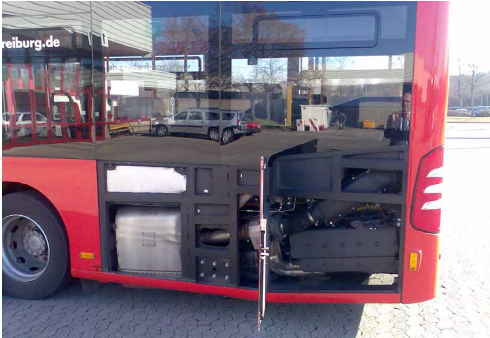
BlueTec-Einheit im Heck eines Busses
